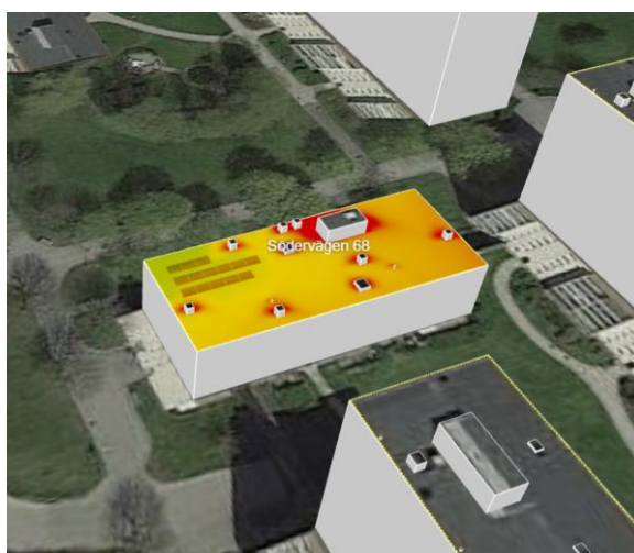
Figur 8 Södervägen 68 kan få endast 5,6kW pga skuggning
